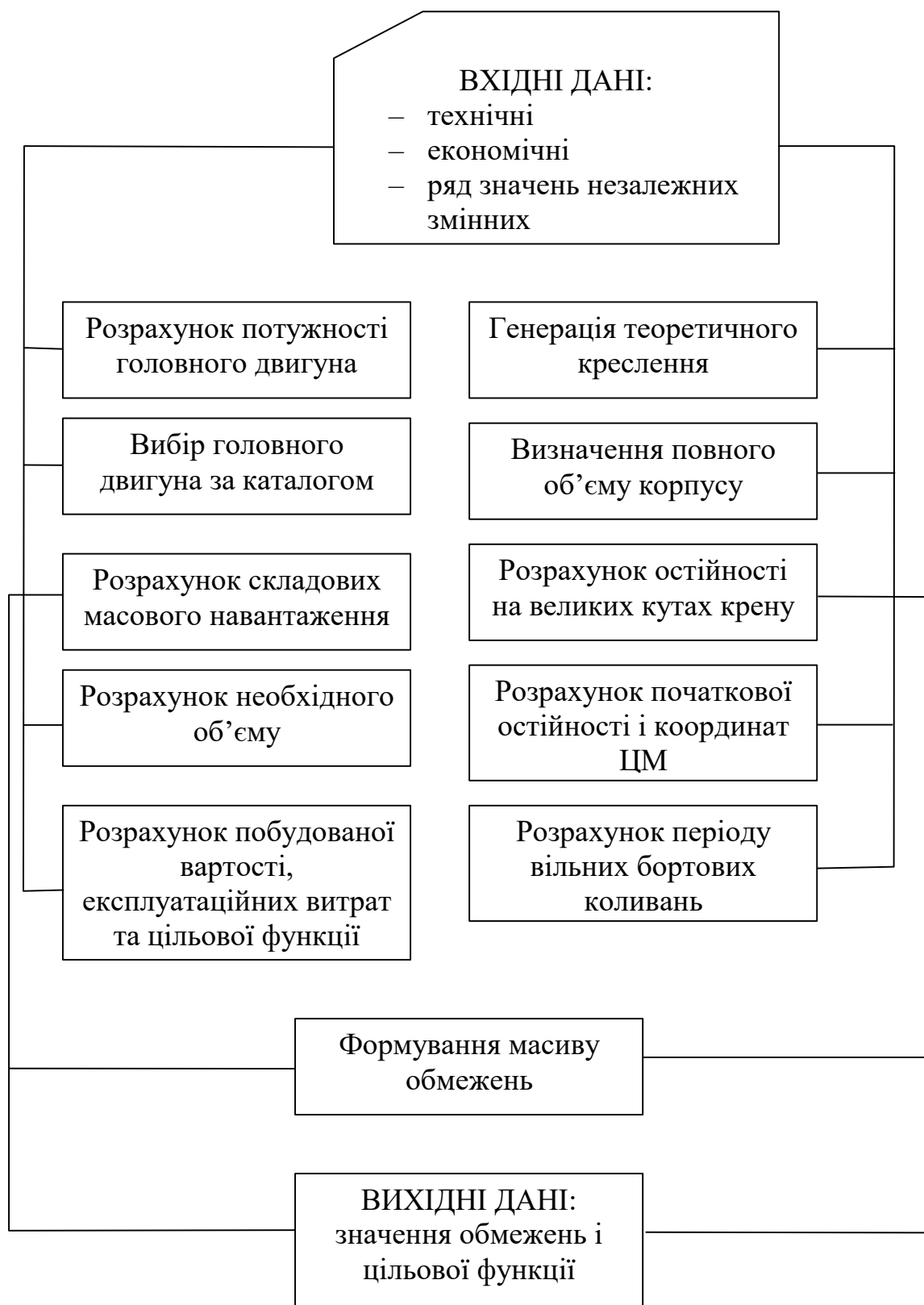
Рис.3.1 Блок-схема математичної моделі малотоннажного судна
