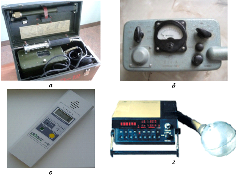
Рис. 10.6. Радіометри: а – ДП-12; б – «Луч-А»; в – РКС-01 «Стора»; г – РПН-07
