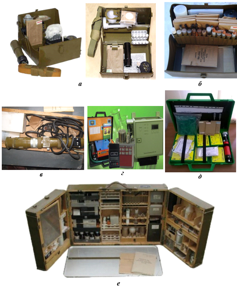
Рис. 10.12. Прилади хімічної розвідки: а – ВПХР; б – ПХР-МВ; в – НПХР; г – УПГК; д – міні-експрес- лабораторія «Бджілка-Р»; е – польова хімічна лабораторія ПХЛ-54
