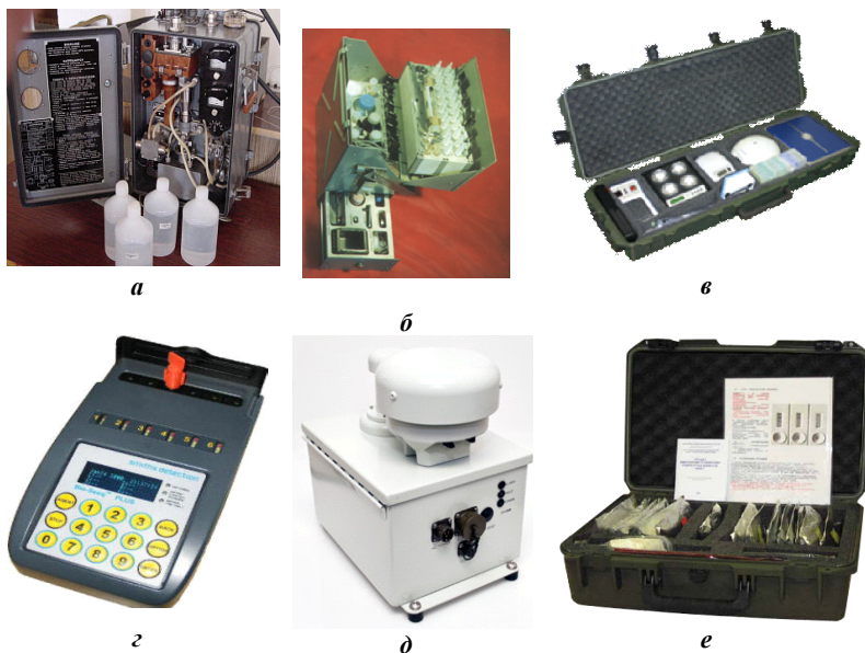
Рис. 10.13. Прилади біологічного моніторингу: а – автоматичний сигналізатор спеціальних домішок АСП-13; б – комплект засобів для аналізу проб уніфікований (КЗАП-У); в – мобільний комплект біологічного контролю (МКБК); г – прилад «Bio-Seq PLUS»; д – прилад «FLIR IBAC»; е – укладка імунохроматографічних індикаторних елементів УІХЕ-1
