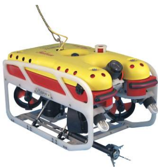
Рис. 4.20 – Сучасні прив'язні ПА та сили, що прикладаються до їх корпусів: a – ПА проекту «Інспектор» з двома маршовими ЕРП (Україна, НУК); б – ПА проекту «Falcon» з чотирма ЕРК для маршового і лагового руху (Швеція, “SAAB”).
