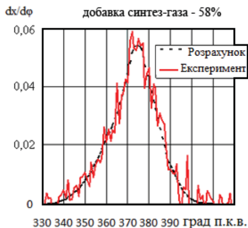
Рис. 2. Розрахункові і експериментальні характеристики тепловиділення при роботі двигуна 2С 7,2/6 на бензині з добавками синтез-газу
