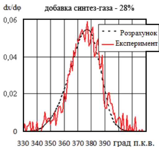
Рис. 1. Індикаторна діаграма двигуна 2С 7,2/6 при різних добавках синтез-газу до бензину: 1 – бензин; 2, 3, 4 – добавка синтез-газу 28%, 32% і 64% відповідно
