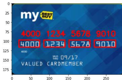
Рисунок 2.1 – Приклад опрацювання фото через Template matching
