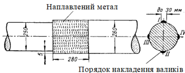
Рис. 1.22. Наплавлення шийки балера керма.
