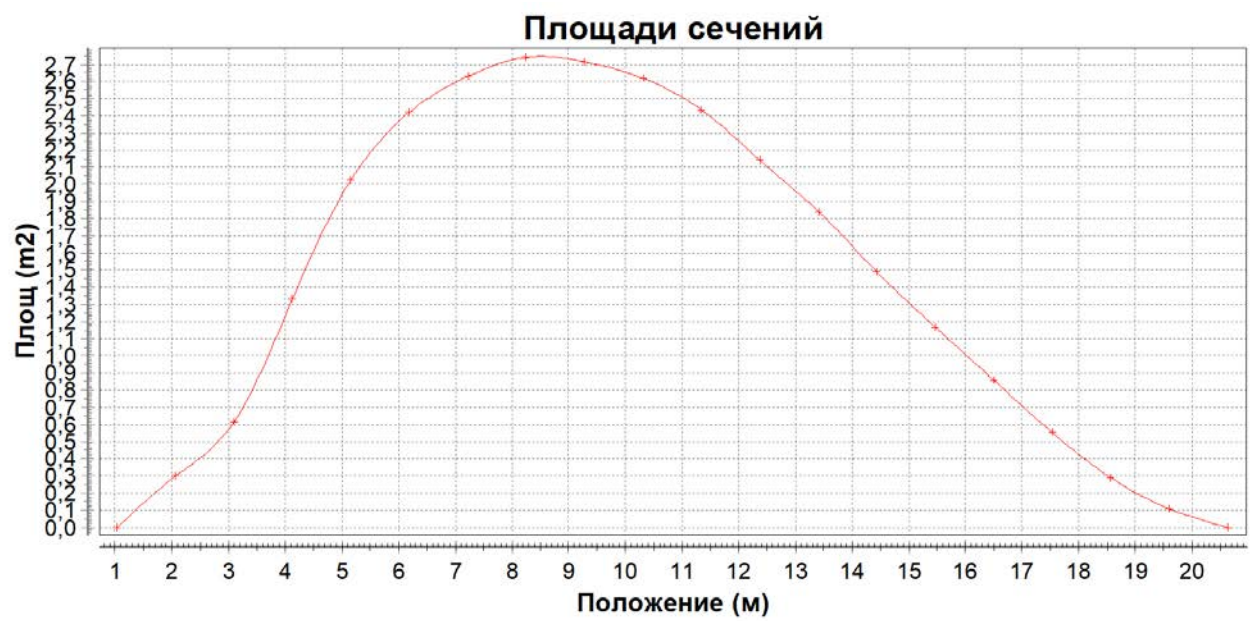
Рис 2.2 Площини шпангоутів по довжині судна
