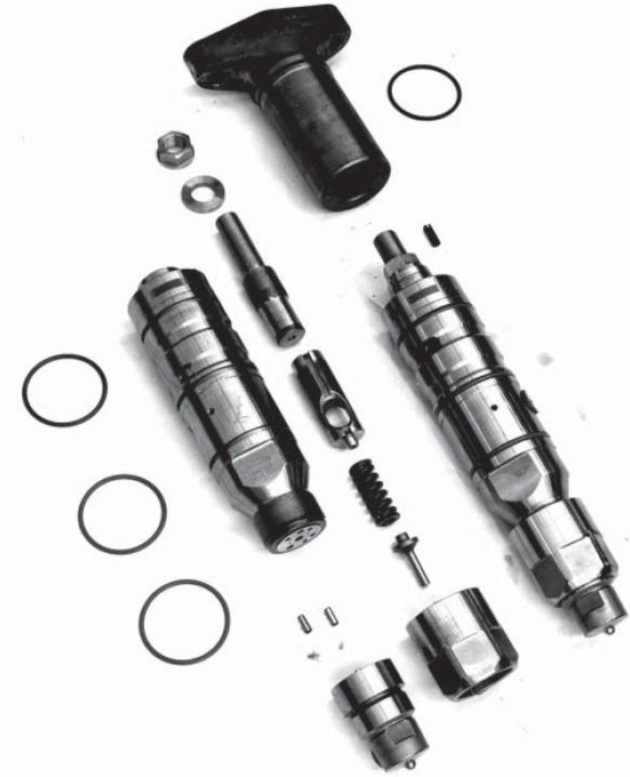
Рисунок 1.11 – Складові елементи паливної форсунки дизеля серії L58/64
