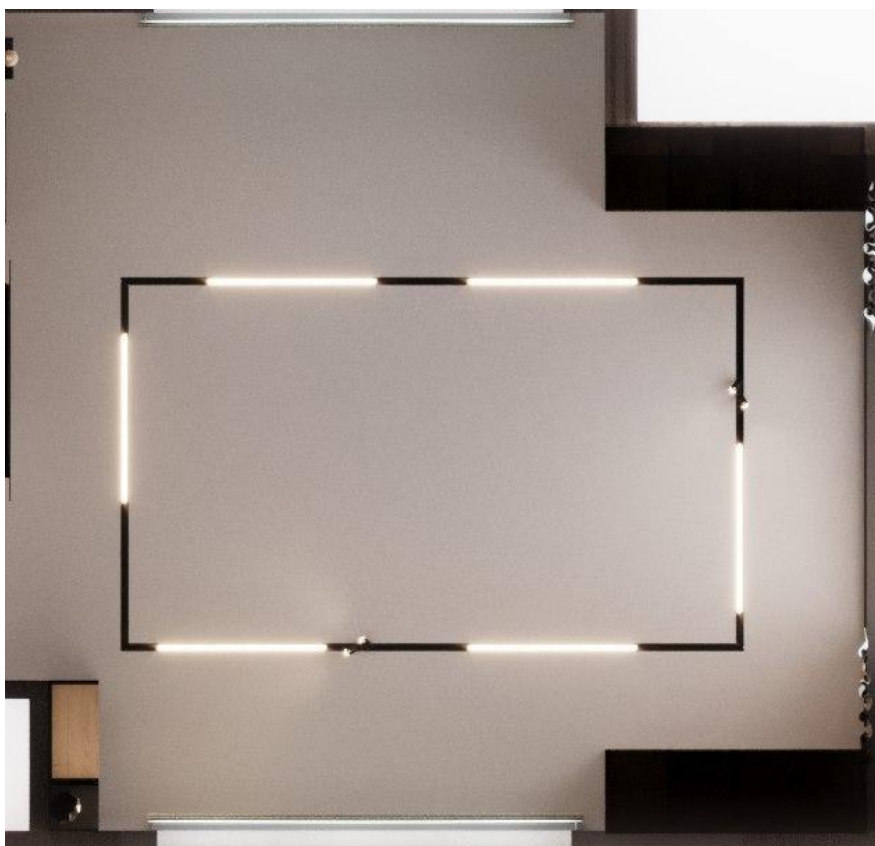
Рис.7.1. План освітлення в салоні моторної яхти Cantiere delle Marche rj-115.
