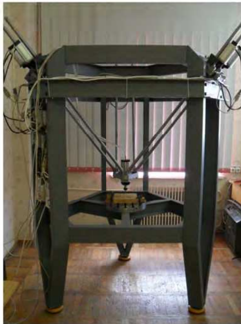
Рисунок 3.1 Фізичний прототип механізму паралельної структури на основі платформи Стюарта
