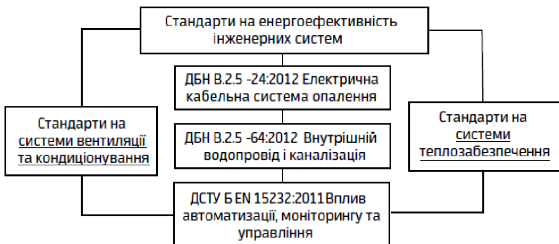
Рис. 1.5. Стандарти на енергоефективність інженерних систем будівель.
