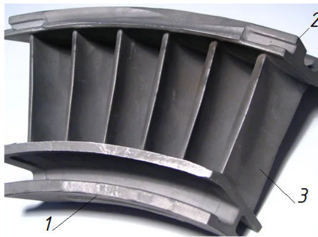
Рисунок 2.2 – сопловий апарат осьової турбіни турбонагнітача з нерухомою лопатковою решіткою: 1 – зовнішнє кільця; 2 – внутрішнє кільце; 3 – лопатки
