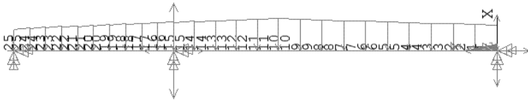
Рис. 3. Скінчено-елементна модель бортового перекриття із прикладеним експлуатаційним навантаженням
