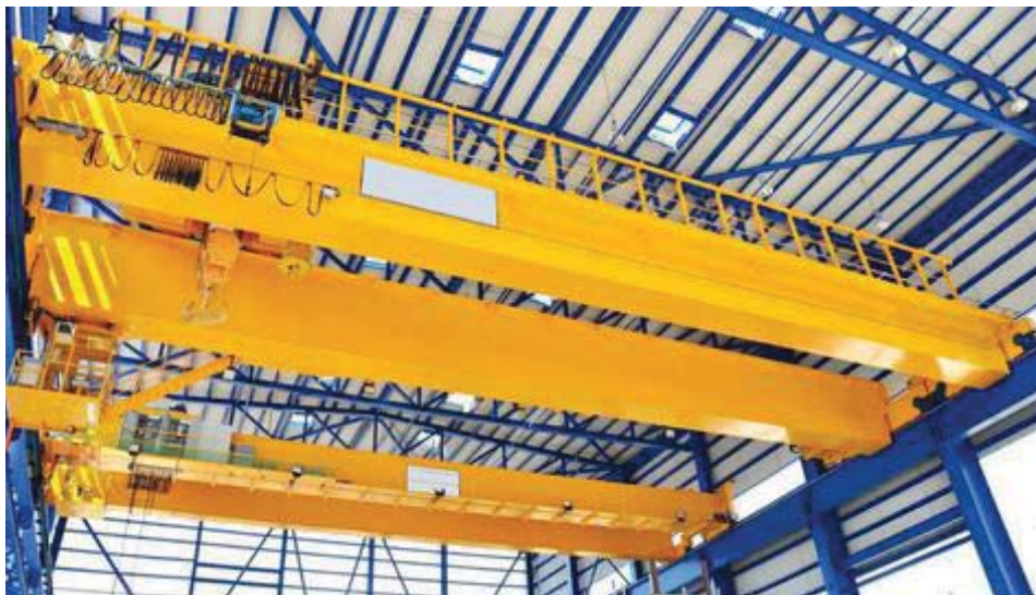
Рисунок 1 – Зовнішній вигляд мостового двобалочного крана
