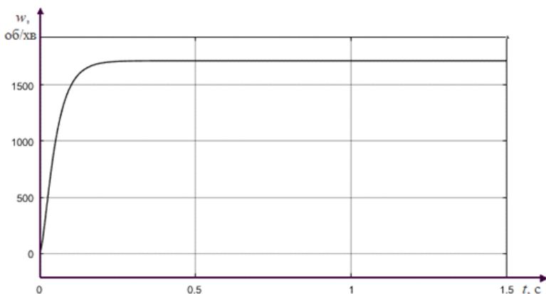
Рис. 4.4. Моделювання перехідного процесу частоти обертання двигуна в Simulink
