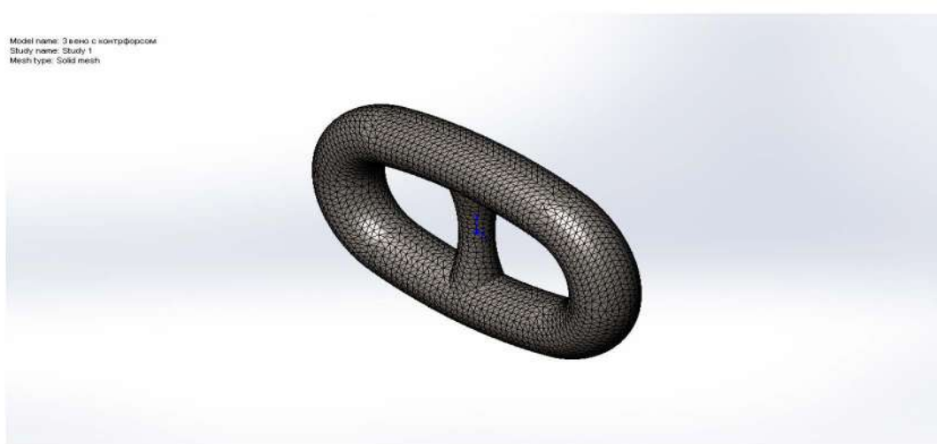
Рисунок 4.11 – Розбивка на кінцеві елементи
