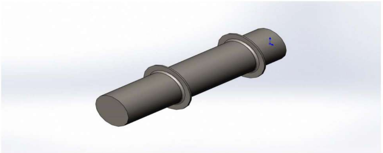
Рисунок 7.7 - Розрахункова модель вала якірної лебідки
