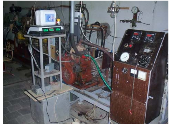
Рис. 3. Загальний вигляд експериментального стенду та панелі приладів стенда на базі двигуна з примусовим запалюванням 2Ч 7,2/6
