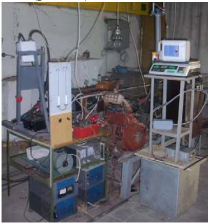
Рис. 3. Загальний вигляд експериментального стенду та панелі приладів стенда на базі двигуна з примусовим запалюванням 2Ч 7,2/6
