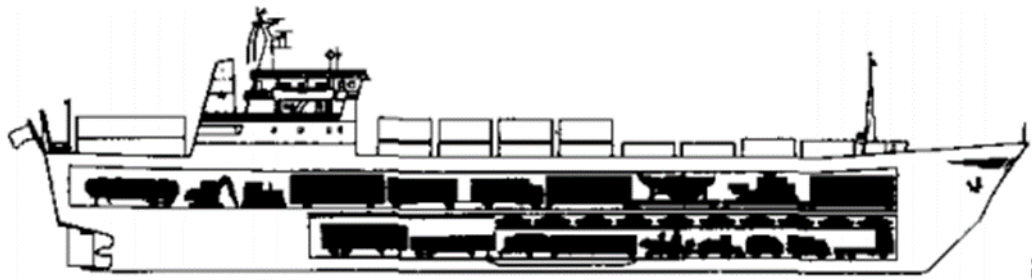
Рис. 1 Схема судна з горизонтальною вантажообробкою з різними вантажами на борту
