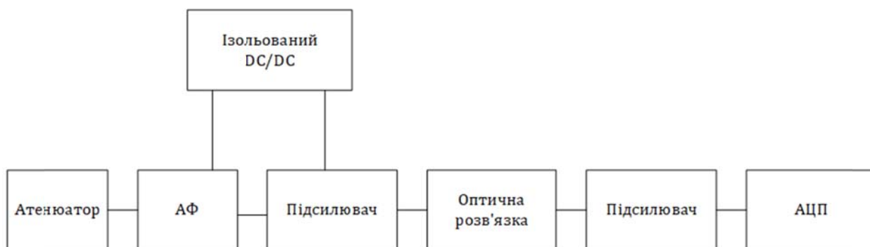
Рисунок 2.2 – Структурна схема ізолюваних каналів
