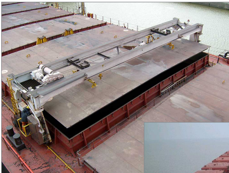
Рис. 5.1. Торговое судно со сдвигающимися посредством траверсы люковыми крышками
