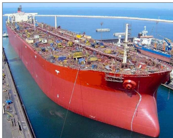
Рис. 2.8. Судно с большим значением коэффициента полноты мидель-шпангоута и большим значением коэффициента общей полноты
