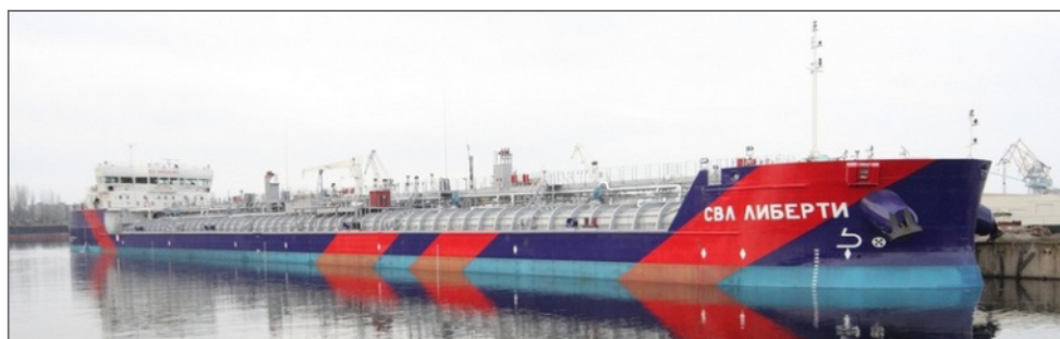
Рис. 1.8. Танкер-продуктовоз (проект RST27)
