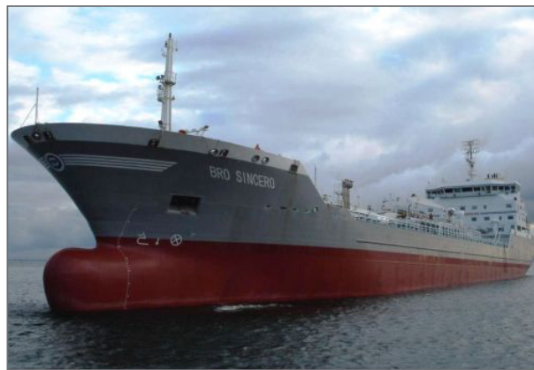
Рис. 2.7. Судно с малым значением коэффициента общей полноты и большим значением коэффициента полноты мидель-шпангоута
