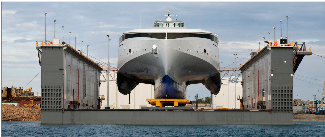
Рис. 7.6. Плавучий док: а — общий вид; б — вид на докующееся судно
