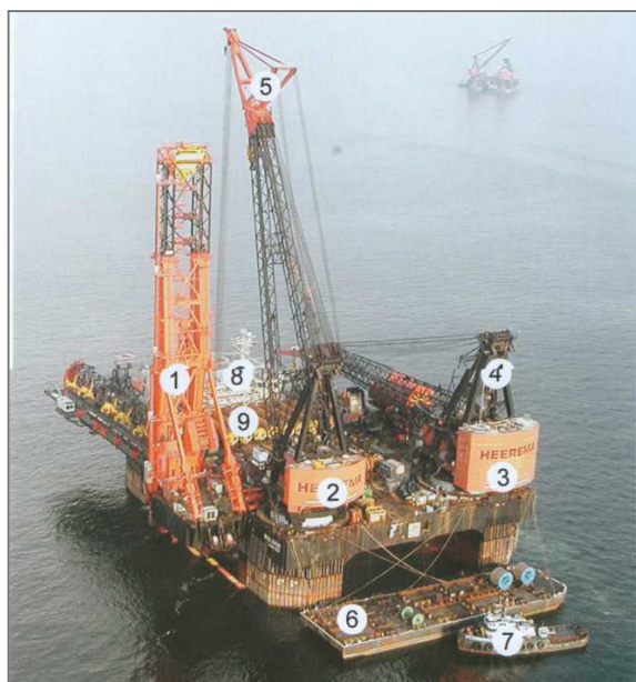
Рис. 3.36. Полупогружное крановое судно для подъема тяжелых модулей и укладки труб:
