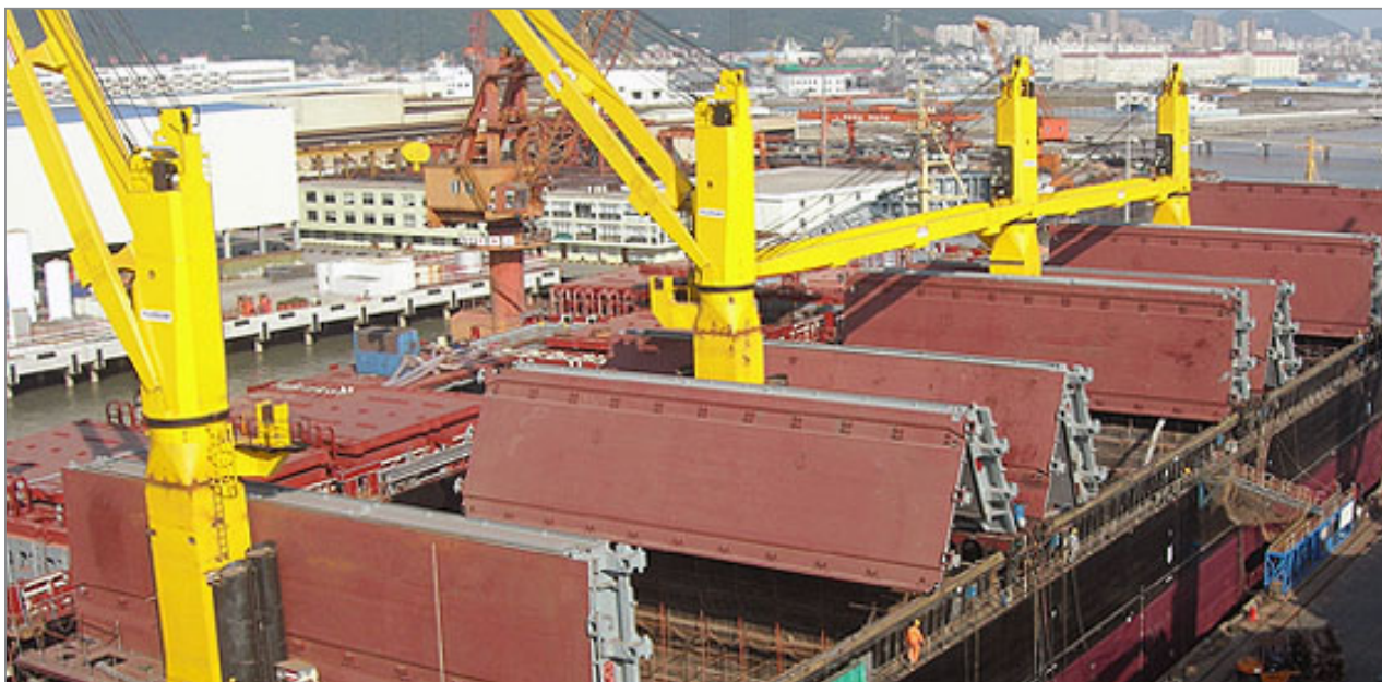
Рис. 5.3. Судно с секционными откидными люковыми закрытиями
