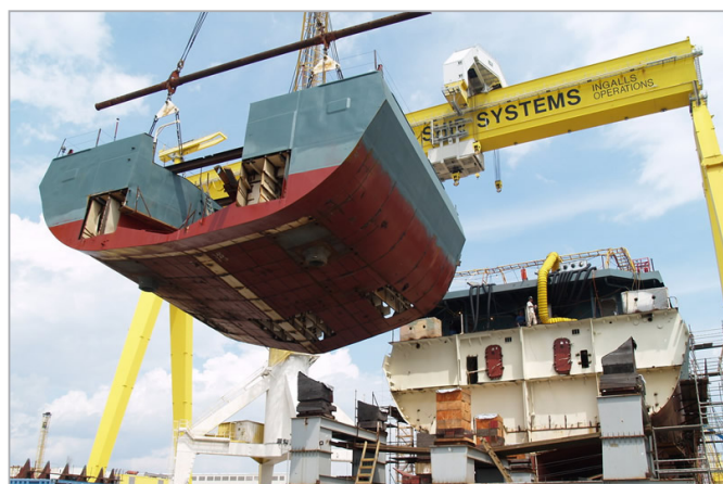
Рис. 4.4. Кормовая оконечность судна: а — установка на судно; б — вид на корму готового судна
