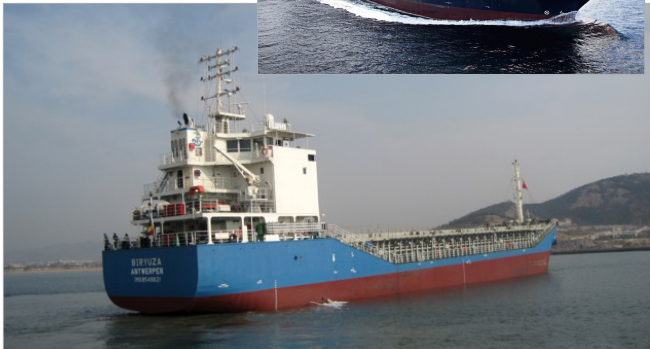
Рис. 3.2. Многоцелевое судно без собственных грузовых устройств «Biryuza»
