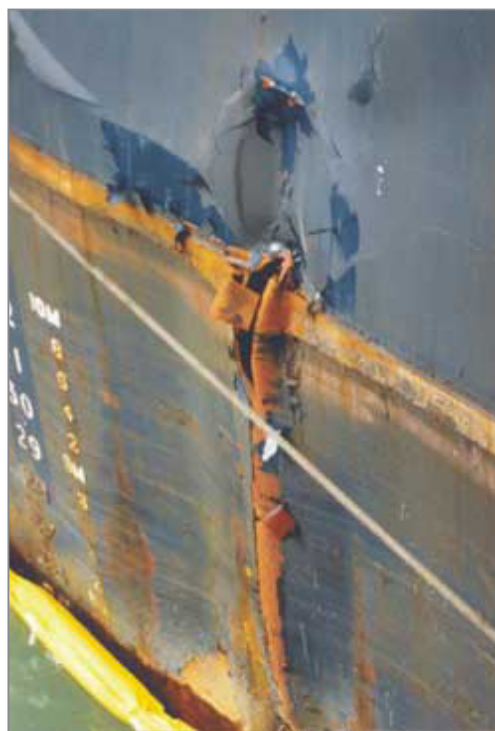
Рис. 6.11. Разрушение конструкции борта в результате действия усталостных напряжений
