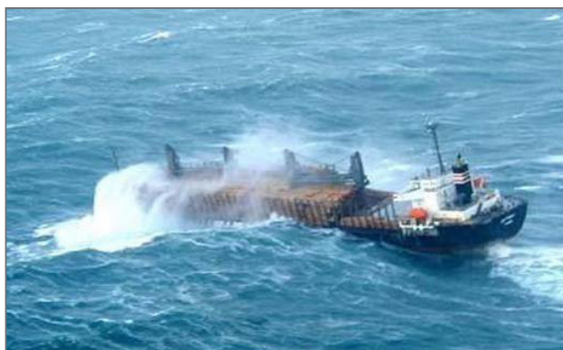
Рис. 6.13. Перегиб корпуса судна, находящегося на вершине волны: a — лесовоза; б — балкера
