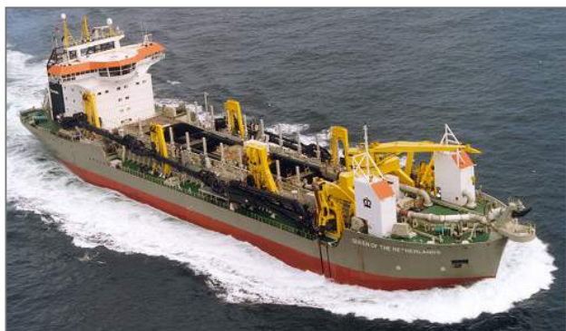
Рис. 3.27. Землечерпалка с кормовым всасывающим бункером: а — общий вид; б — наклонный дождь
