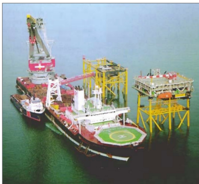
Рис. 3.36. Полупогружное крановое судно для подъема тяжелых модулей и укладки труб:
