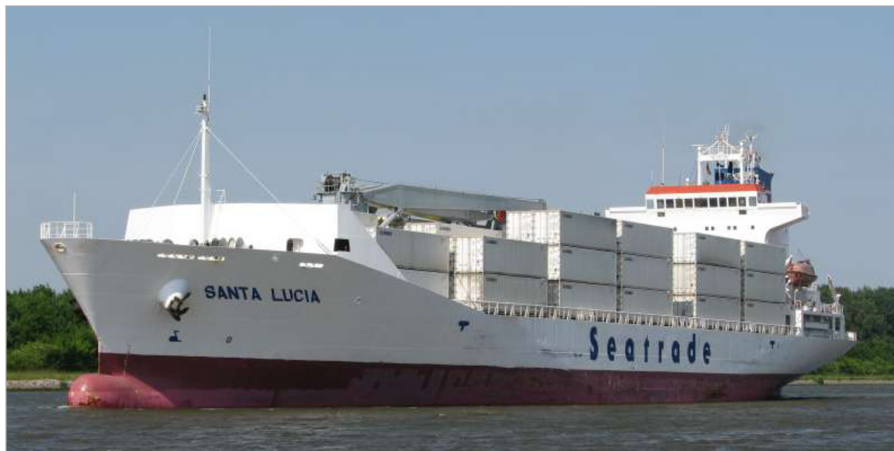
Рис. 3.8 — Рефрижераторное судно «Santa Lucia» (полная грузоподъемность — 8507 т; дедвейт при летней осадке — 9500 т)
