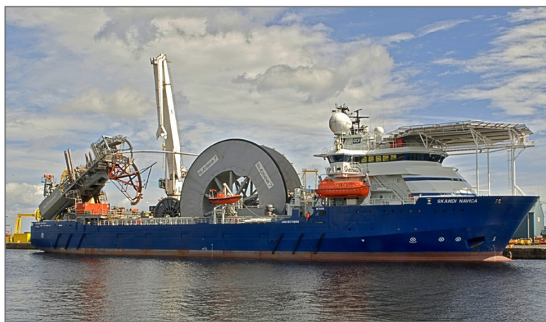
Рис. 3.30. Судно для укладки кабелей: а — в порту; б — в процессе работы
