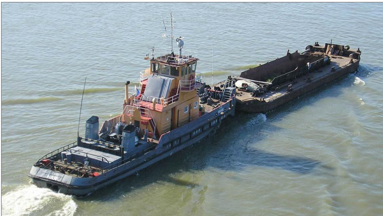
Рис. 3.24. Буксир во время проводки судна путем толкания
