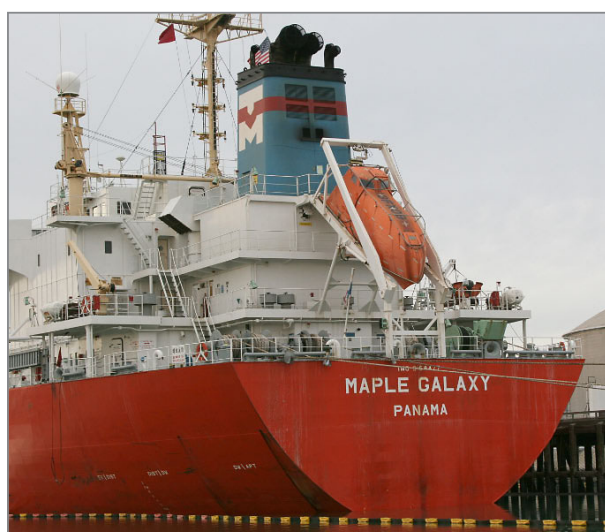
Рис. 5.29. Шлюпка свободного падения, установленная на судне «Maple Galaxy»
