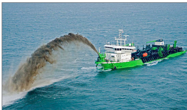
Рис. 3.27. Землечерпалка с кормовым всасывающим бункером: а — общий вид; б — наклонный дождь
