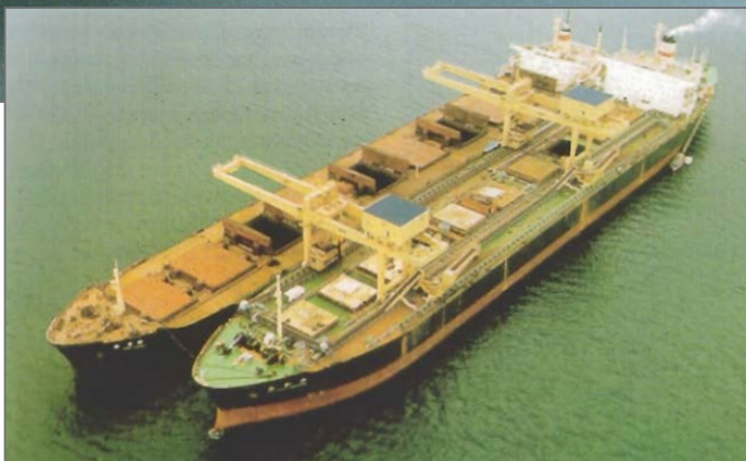
Рис. 3.14. Проведение разгрузочных операций рудовоза на рейде
