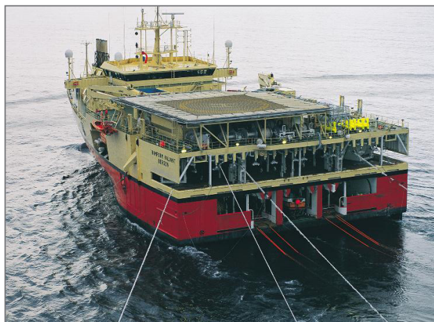
Рис. 3.31. Сейсморазведочное судно: а — общий вид; б — судно во время разведочной операции
