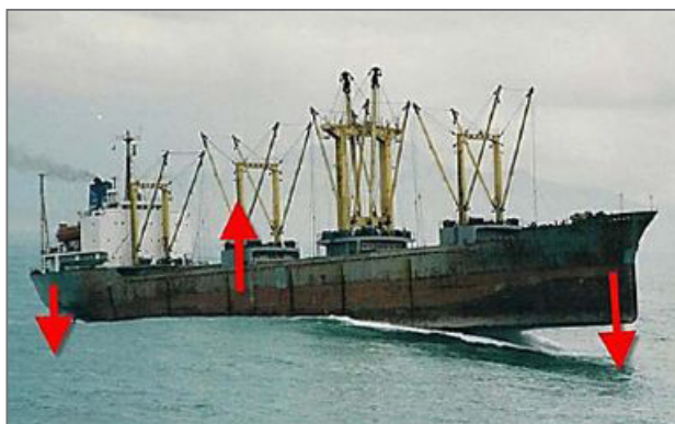
Рис. 6.13. Перегиб корпуса судна, находящегося на вершине волны: a — лесовоза; б — балкера
