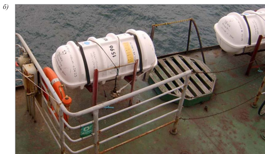
Рис. 5.31. Плот надувного типа: а — трехмерная модель; б — на борту судна
