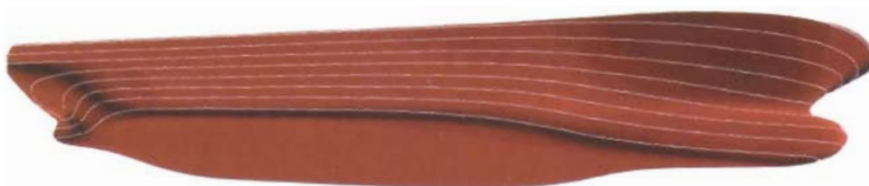
Рис. 2.9. Горизонтальные сечения корпуса судна (ватерлинии)
