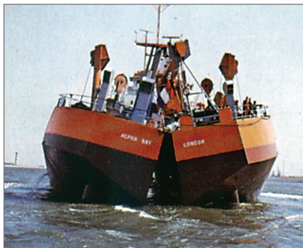
Рис. 3.28. Землечерпалка с раскрывающимся корпусом
