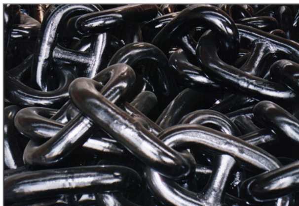
Рис. 5.11. Звенья якорной цепи с распорками
