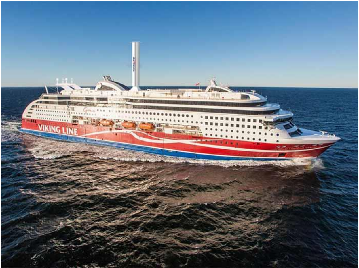
Рис. 2.5. Приклад використання Flettner Rotor на круїзному лайнері (Viking Grace)
