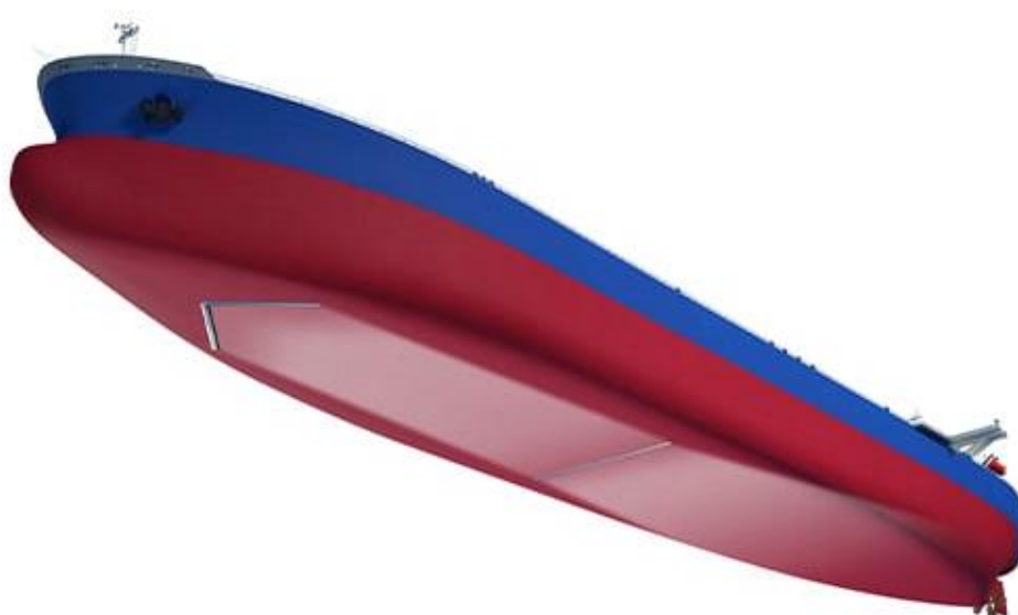
Рис. 2.3. Візуалізація принципу дії Air Lubrication System
