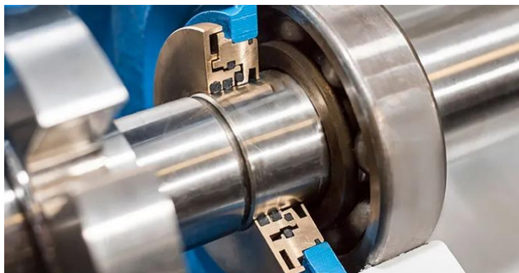
Рис. 3.18. Ізолятор підшипника від компанії SEPCO, Inc. [12]
