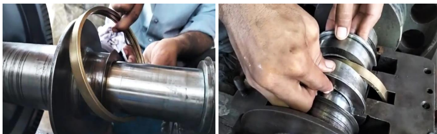
Рис. 3.10. Монтаж масляних кілець
