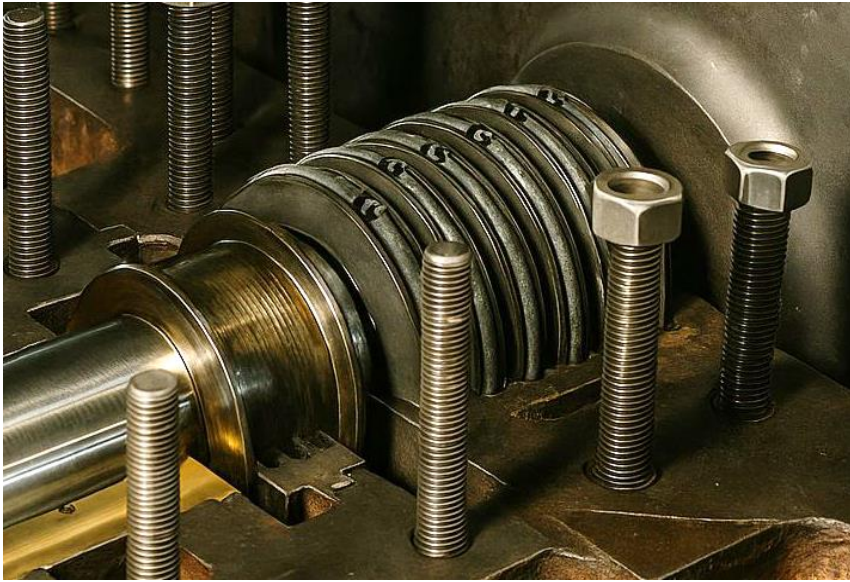
Рис. 3.22. Установлені на валу графітові кільця
