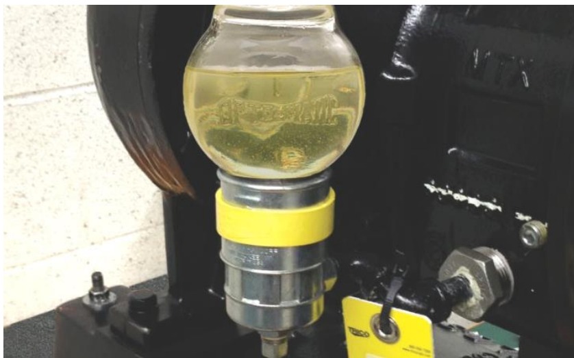
Рис. 3.12. Зовнішній вигляд резервуара з маслом [15]
