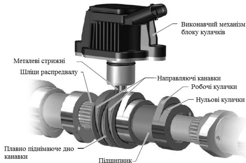
Рис. 3.38. Зсув блоків кулачків
