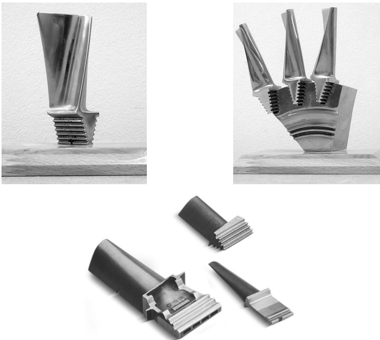
Рис. 1.52. Робочі лопатки з ялинковим хвостовиком
