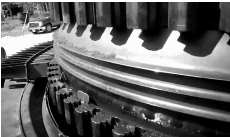
Рис. 4.11. Гребінці лабіринтових ущільнень
