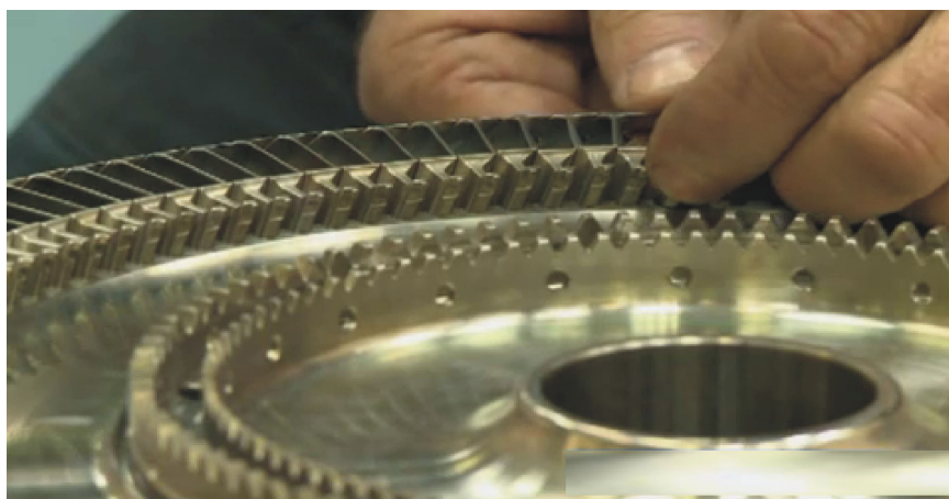
Рис. 2.12. Диск турбіни компанії ОАО "Климов" з трикутними торцевими шліцями
