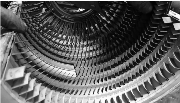
Рис. 1.17. Направні лопатки 10-ступінчастого однокаскадного компресора турбовального двигуна T58 компанії "General Electric Co."
