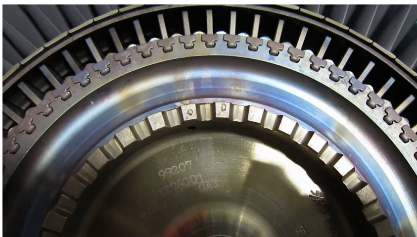
Рис. 2.13. Диск турбіни компанії "General Electric Co." з торцевими шліцями типу Курвік
