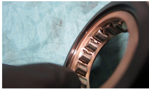
Рис. 3.8. Роликовий підшипник з масивним бронзовим сепаратором
