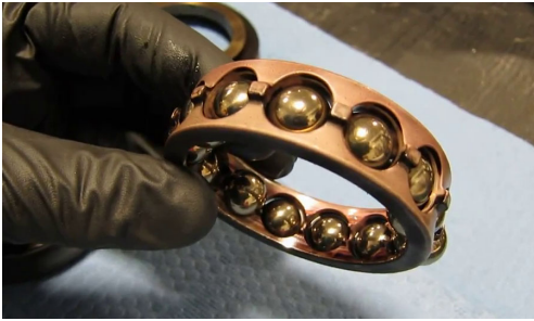
Рис. 3.7. Масивний бронзовий сепаратор кулькового підшипника
