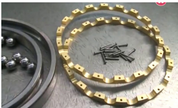
Рис. 3.6. Розібраний кульковий підшипник із клепанним сепаратором
