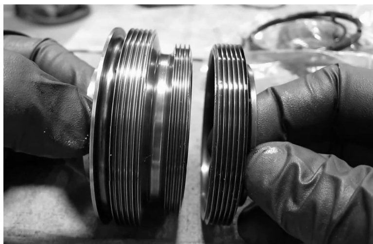
Рис. 4.24. Елементи двоярусних лабіринтових масляних ущільнень
