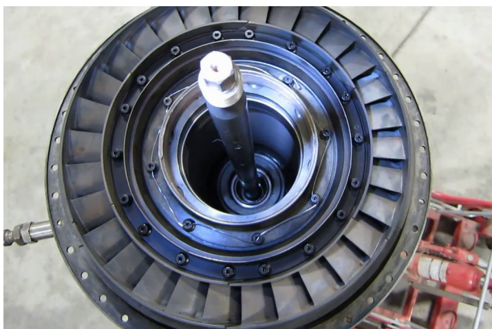
Рис. 2.9. Установлення центрального стяжного болта на турбовальному двигуні Т58 компанії "General Electric Co."
