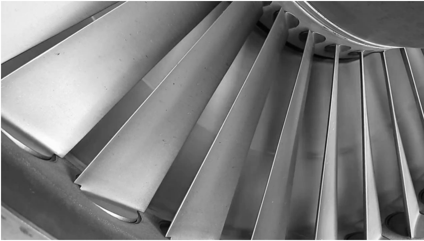
Рис. 1.28. Лопатки вхідного напрямного апарата двигуна J79
