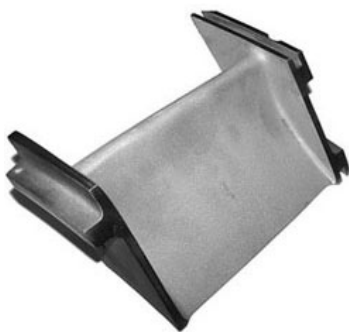
Рис. 1.32. Соплова лопатка двигуна ГТК-10-4 компанії ЗАО "Невский завод"
