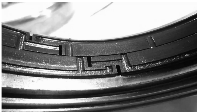
Рис. 4.30. Дворядне графітове контактне ущільнення (вигляд за розрізами кілець)
