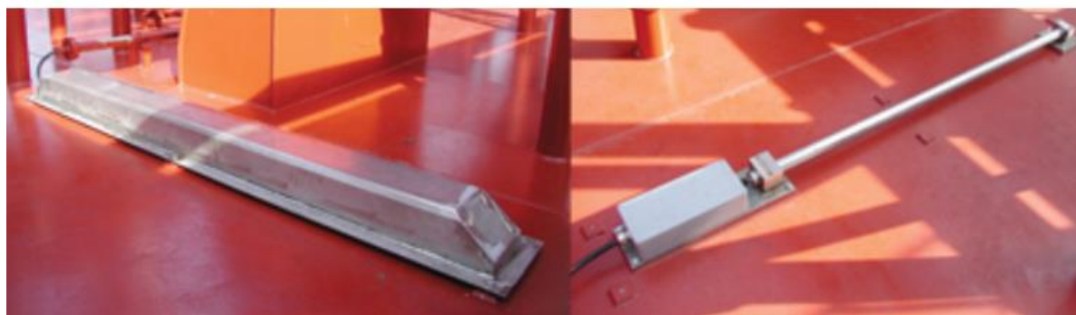
Рис. 5.10 Датчик «LBSG» для вимірювання деформації вздовж центральної лінії судна [32]
