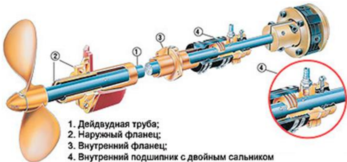
Рисунок 2.6 – Схема суднового валопроводу
