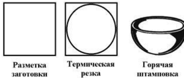
Рисунок 1.5. Послідовність операцій при виготовленні донця
