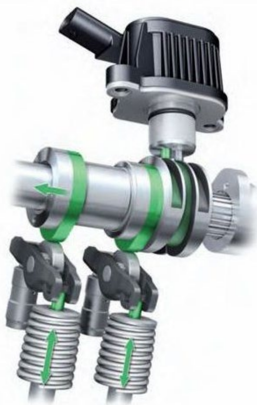
Рис. 1.4. Система відключення циліндрів
