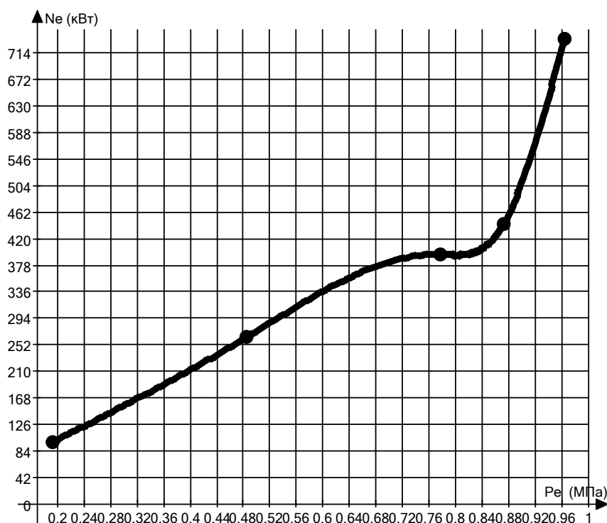
Рис. 3.13. Залежність ефективної потужності від середнього ефективного тиску
