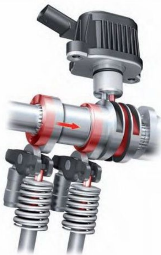
Рис. 1.4. Система відключення циліндрів
