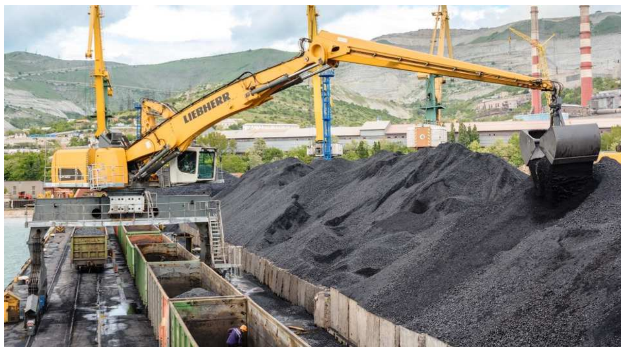
Рисунок 2.3 – Грейферний порталний кран
