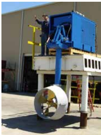
Рис. 4. Модульний гідравлічний підвісний рушій [9]
