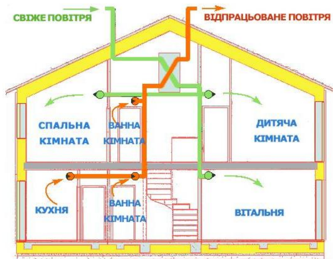
Рис. 3.5. Схема припливно-витяжної вентиляції з рекуперацією тепла
