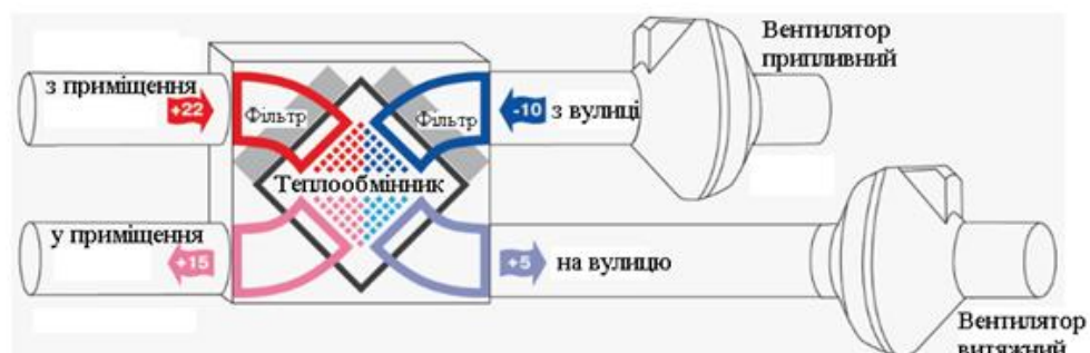
Рис. 2.17. Принцип дії припливно-витяжної вентиляції з рекуперацією тепла
