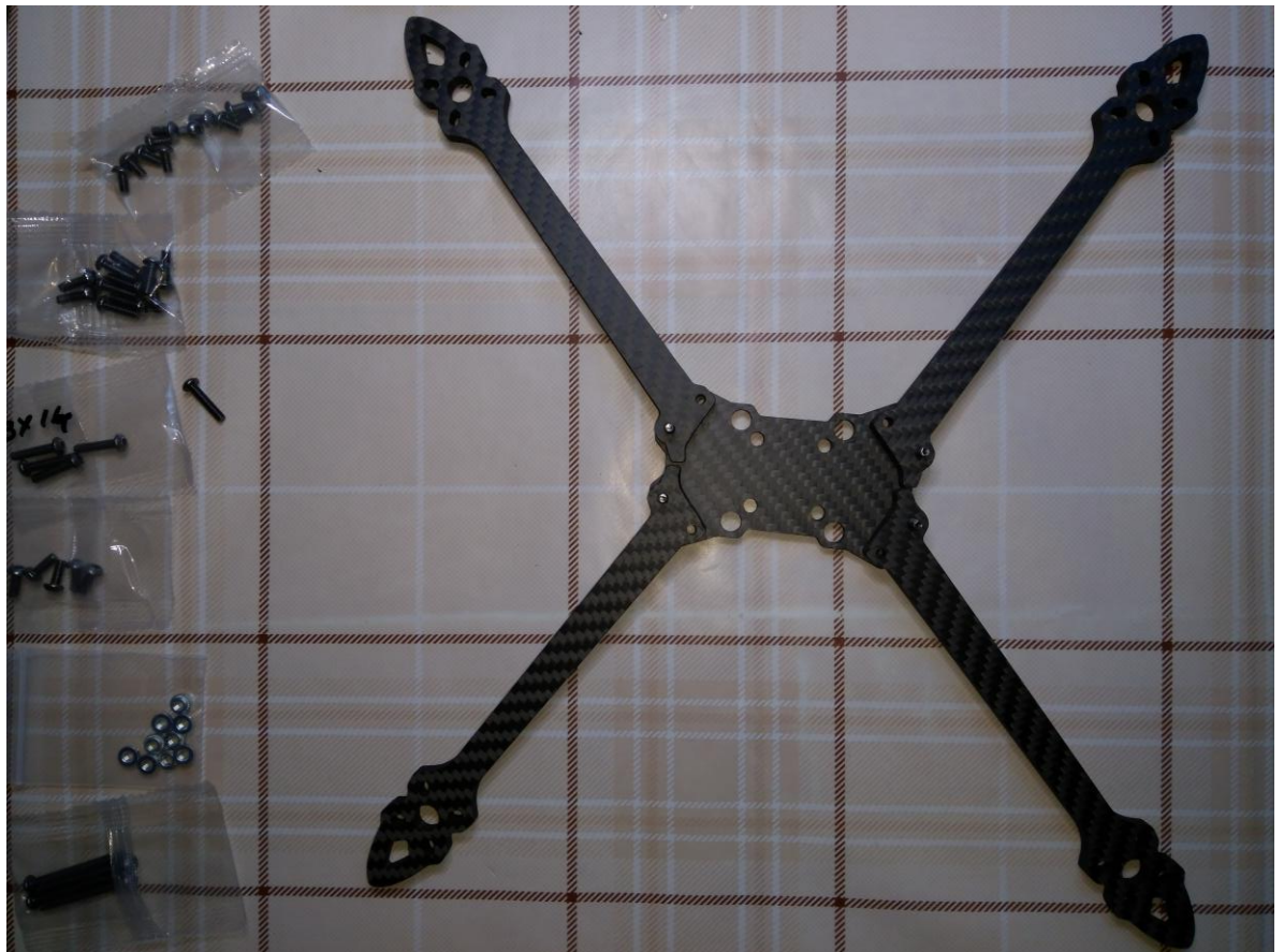
Рис. 3.2 – Компоненти рами Mark4 V2 7" перед збіркою
