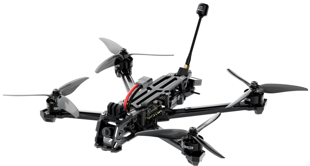
Рис. 1.8 – FPV-дрон GEPRC Vapor-D6 на прошивці Betaflight
