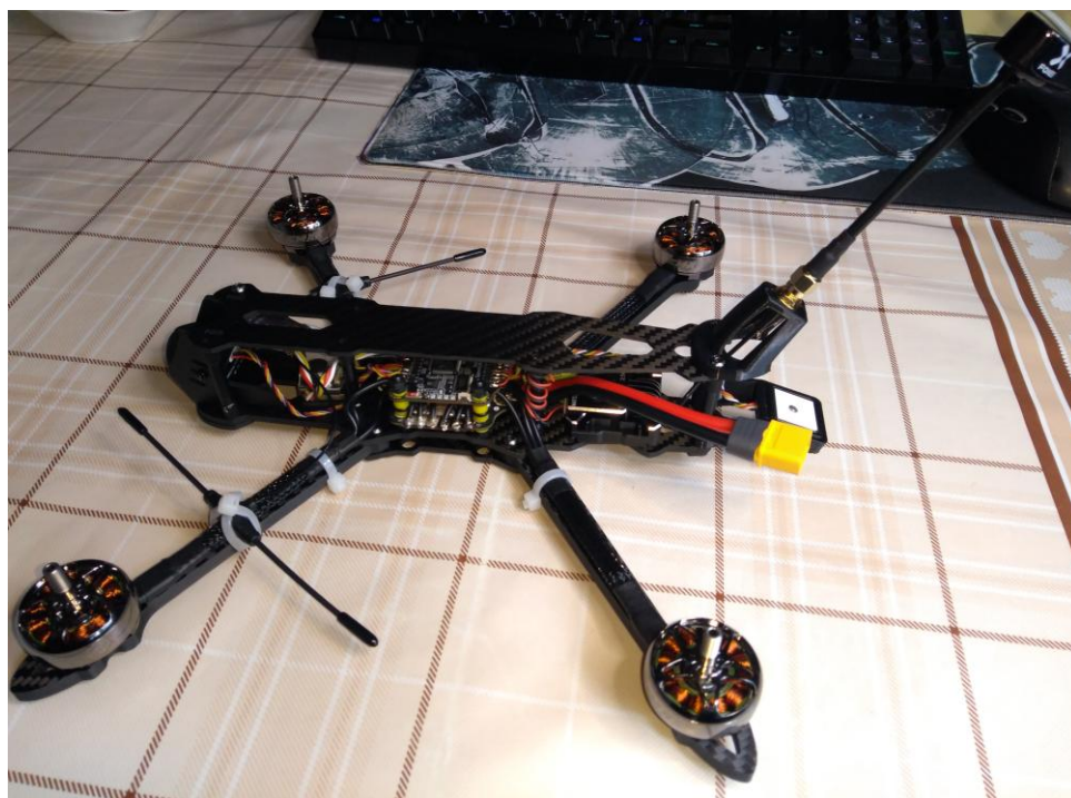
Рис. 3.12 – Остаточна збірка рами інспекційного дрона
