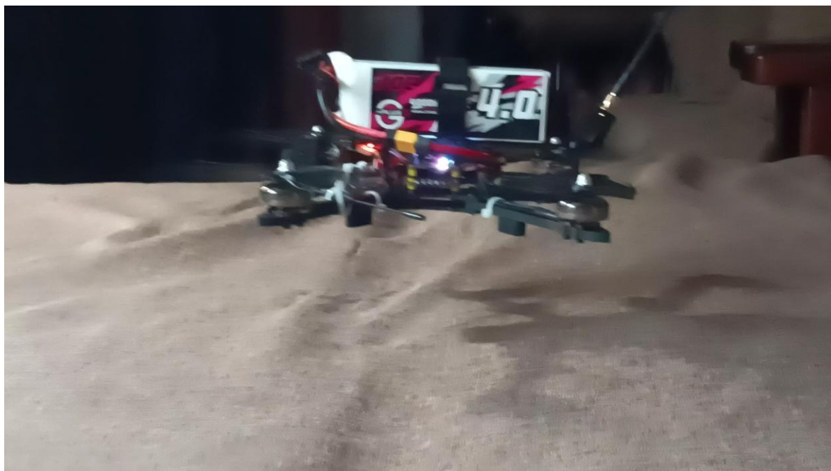
Рис. 3.18 – Інспекційний дрон у режимі зависання на висоті ~10 см над поверхнею під час тестування у приміщенні
