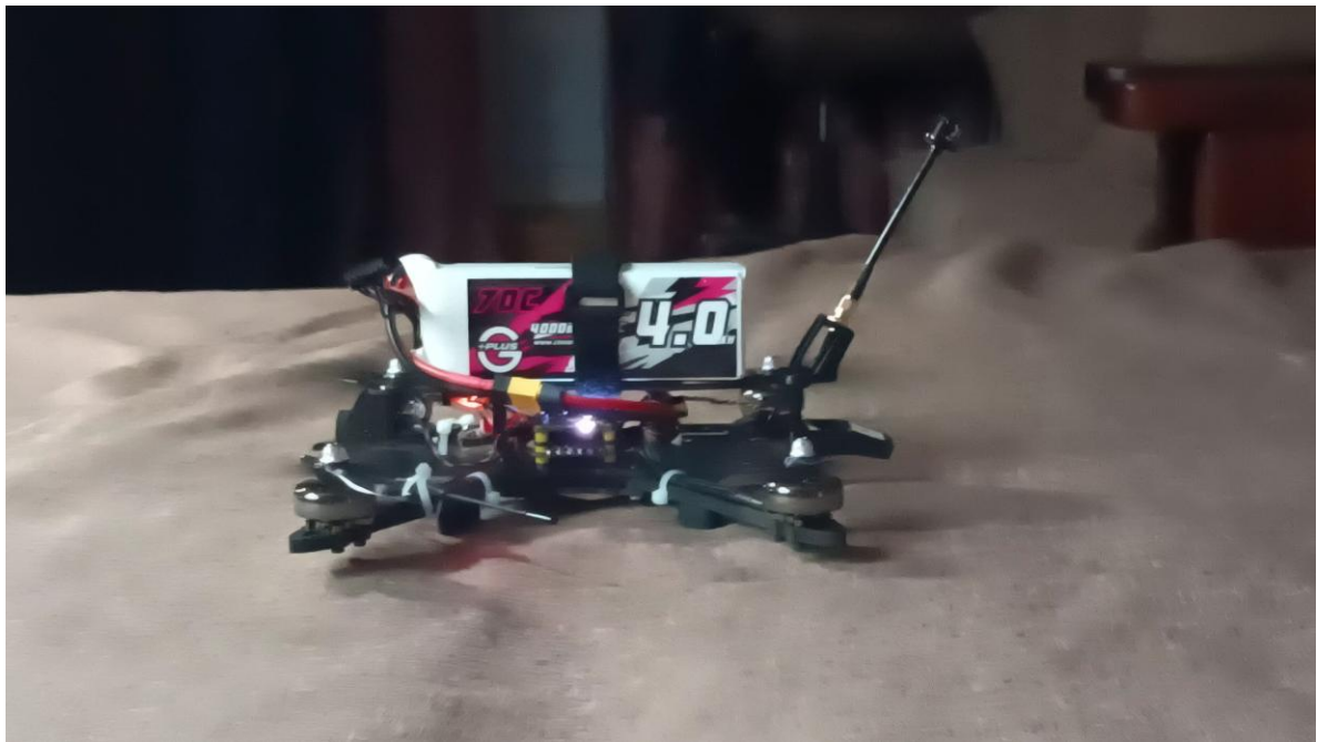
Рис. 3.17 – Інспекційний дрон у стартовій позиції перед тестовим польотом у приміщенні
