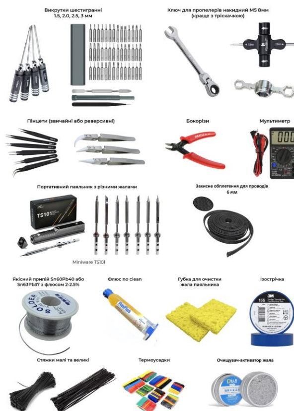
Рис. 3.1 – Загальний набір інструментів та матеріалів для збірки та паяння дрона
