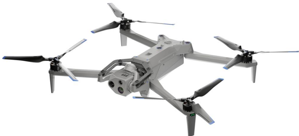
Рис. 1.4 – Інспекційний дрон Skydio X10D з акцентом на автономність
