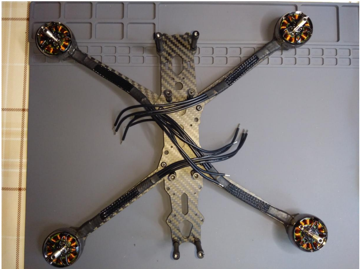
Рис. 3.5 – Усі чотири мотори EMAX ECO II 2807, встановлені на раму Mark4 V2
