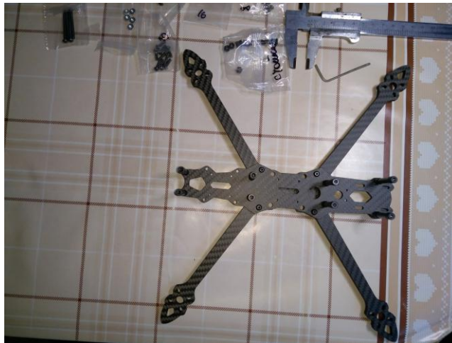
Рис. 3.3 – Зібрана центральна частина рами з встановленими променями та стійками
