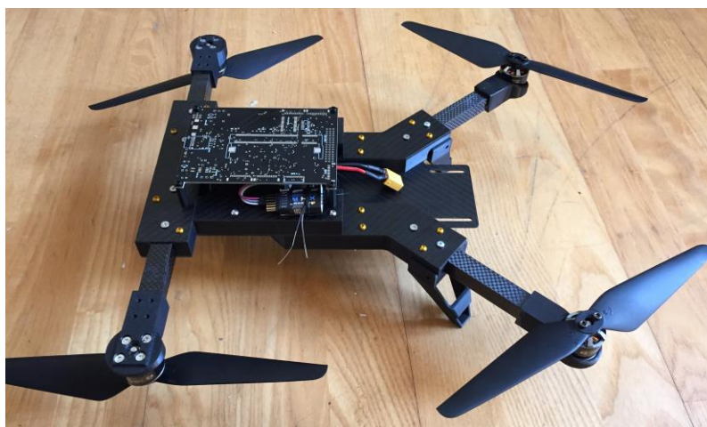
Рис. 1.7 – Інспекційний дрон для внутрішніх приміщень з дослідження NTNU [10]
