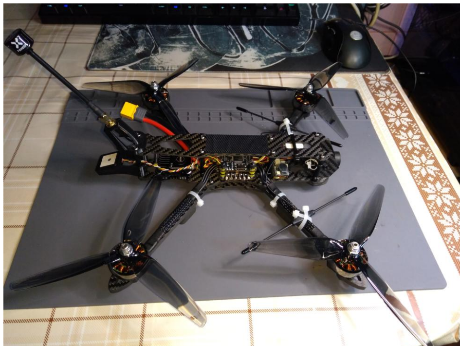
Рис. 3.13 – Встановлення пропелерів на двигуни та фінальне закріплення елементів
