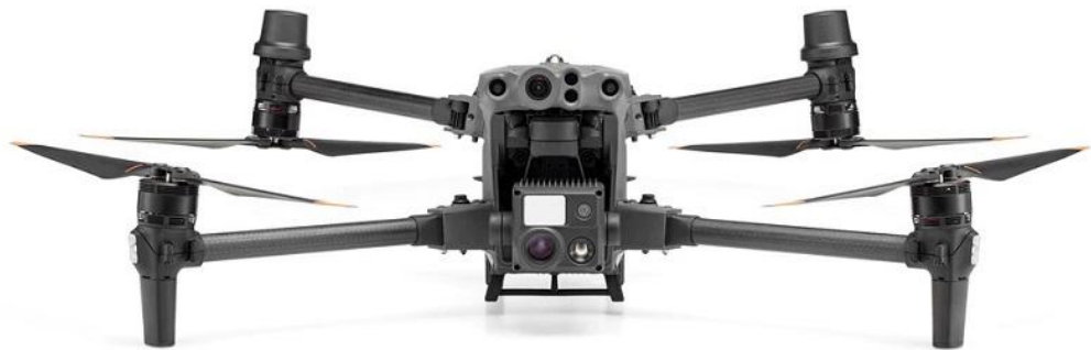
Рис. 1.3 – Професійний інспекційний дрон DJI Matrice 30
