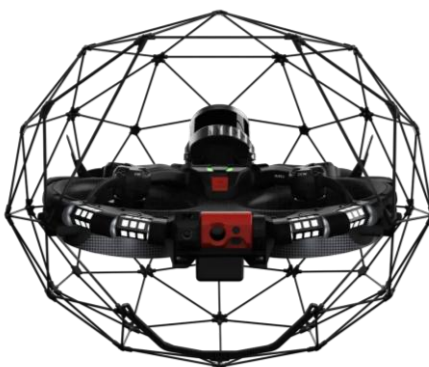
Рис. 1.5 – Інспекційний дрон Flyability ELIOS 3 для замкнених просторів
