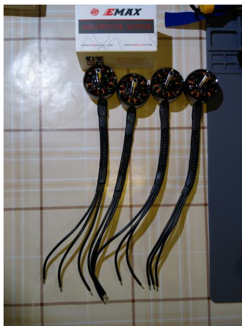
Рис. 3.4 – Захист проводів мотора за допомогою обплетення та термоусадки
