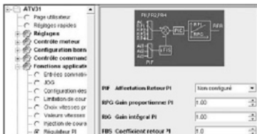
Рис. 6.17. Екран ПЗ PowerSuite: завдання параметрів ПІ-регулятора
