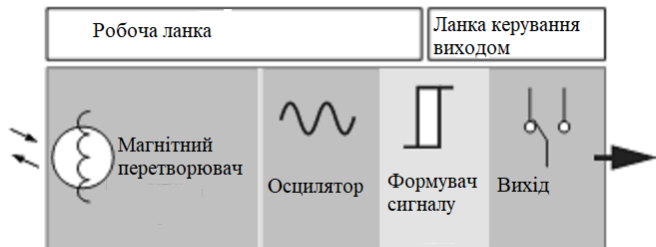
Рис. 5.5. Схема індуктивного датчика
