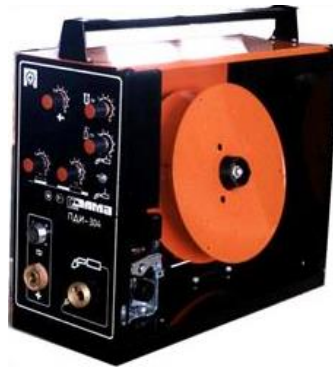
Рис. 3.3. Подавальний механізм апарата для механізованого зварювання ПДИ-304
