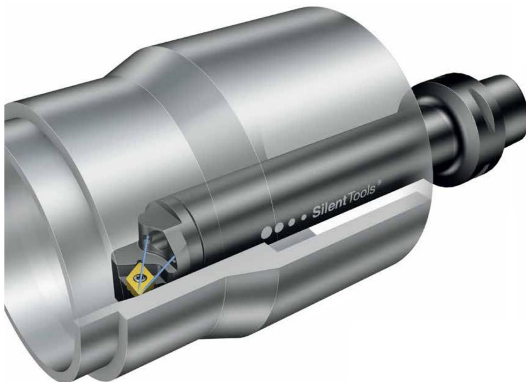
Рис. 2.2. Сталева антивібраційна оправка Silent Tools для внутрішньої токарної обробки
