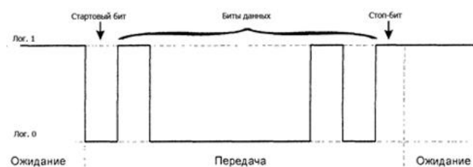
Рис. 2.15 – Передача байту 10000010 через UART
