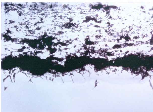
Рисунок 3.5 Мікроструктура термообробленого плазмового покриття чавун + 20 % міді на 18ХНВА [ \times 500 ]
