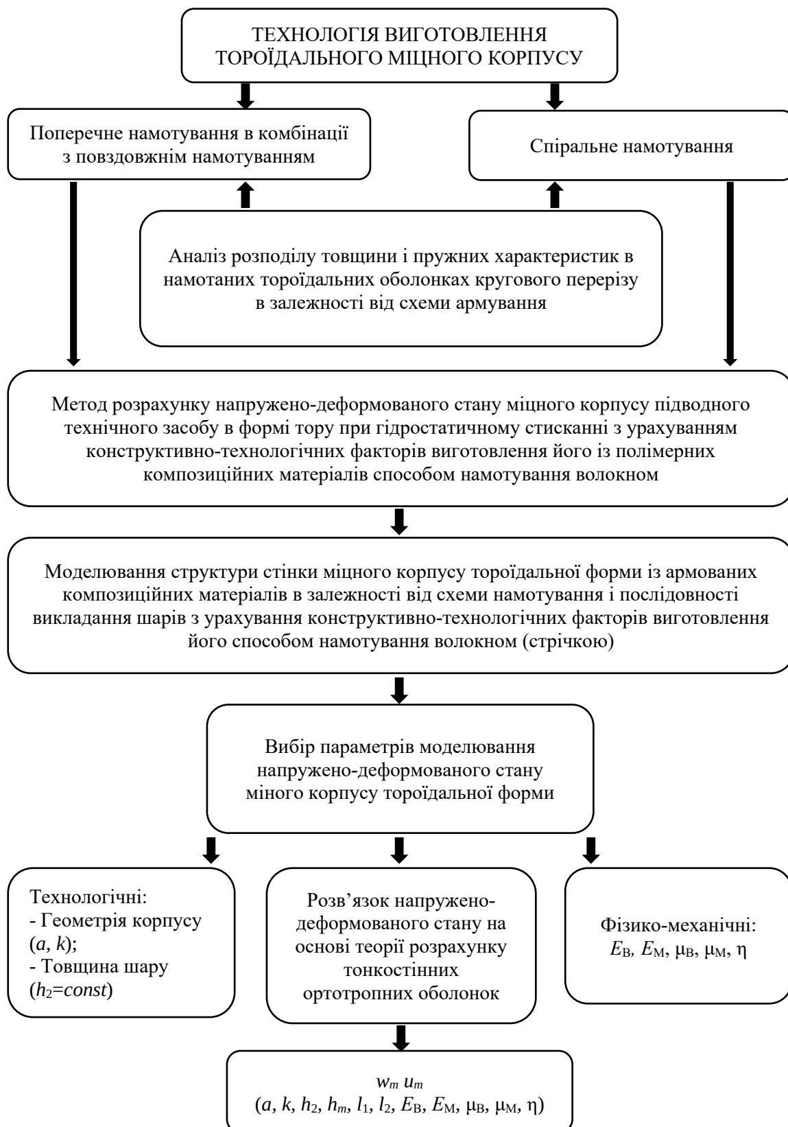
Рисунок 3.2 – Метод розрахунку НДС тороїдального міцного корпусу, виконаного методом намотування із односпрямованого ПКМ, при гідростатичному стисканні
