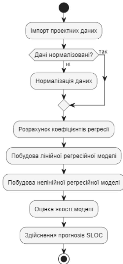
Рисунок 3.5 – Діаграма діяльності «FlutterMediaMetrics» для оцінювання кількості строк коду мультимедійних застосунків для Android, що створюються на платформі Flutter
