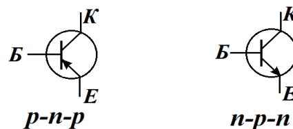
Рис.8.1. Графічне позначення біполярних транзисторів
