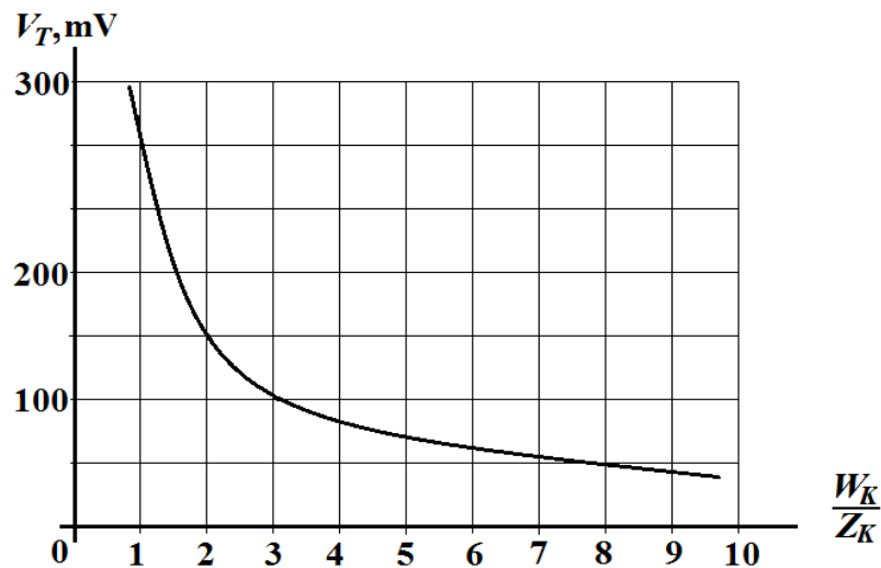
Рис.21.10. Зсув порогової напруги під дією ефекту вузького каналу для МОН транзистора з N_K=10^{15} \text{ см}^{-3} , d_{ox}=500 \text{ нм}
