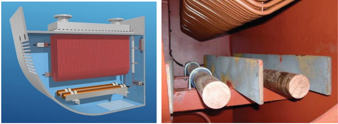
Рисунок 3 – Схема та зовнішній вигляд розміщення анодів системи ICAF
