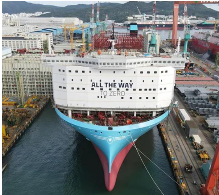
Рисунок 2 – Копенгаген, Данія – A.P. Moller – Maersk (Maersk) – перший із 18 суден-контейнеровозів, двигуни яких використовують метанол в якості палива
