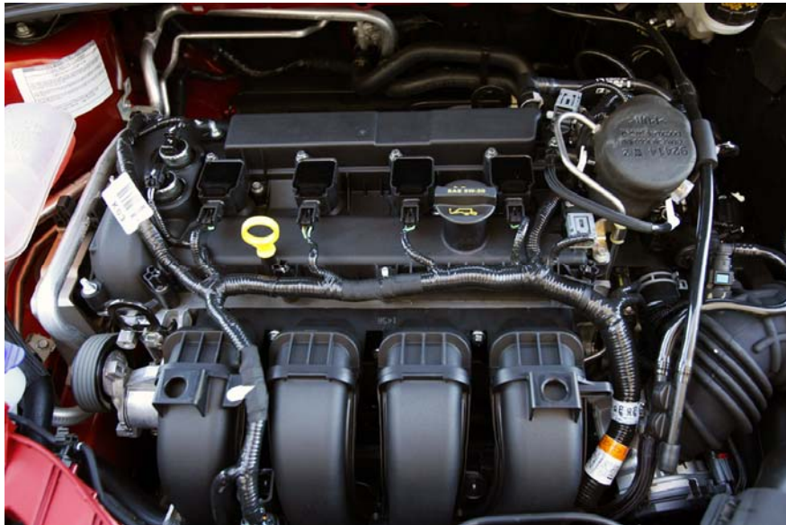
Рисунок 1.2 – Загальний вигляд двигуна 4C8,75/8,31 в підкапотному просторі автомобіля
