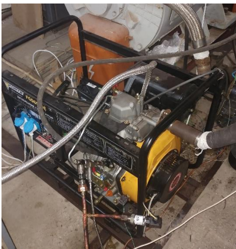
Рис. 4 Загальний вигляд експериментального стенду на базі двигуна 1Ч8,6/7,2 з різним розташуванням клапана подачі водню
