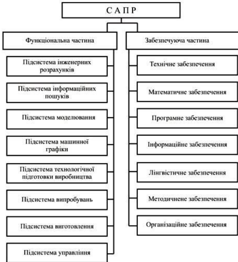
Рисунок 1.5 – Структурна схема САПР
