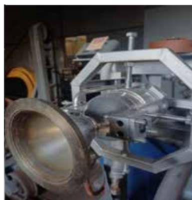
Рис. 1. Фото стендової установки, відпрацювання порожнистої камери на монопаливах
