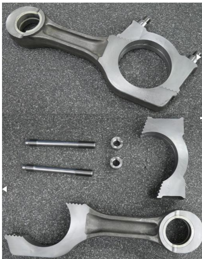
Рисунок 1.5 – Вигляд шатуна та елементів кріплення нижньої головки дизеля 4ЧН 20/28 (Wartsila 4L20)
