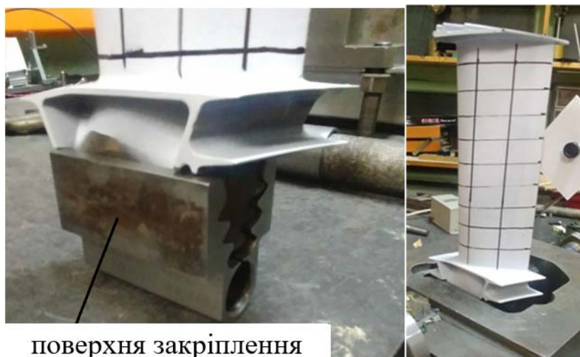
Рисунок 1 - схема закріплення замкової частини робочої лопатки
