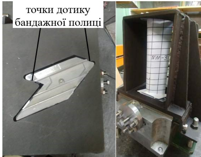
Рисунок 4 – закріплення лопатки з закруткою бандажної полиці
