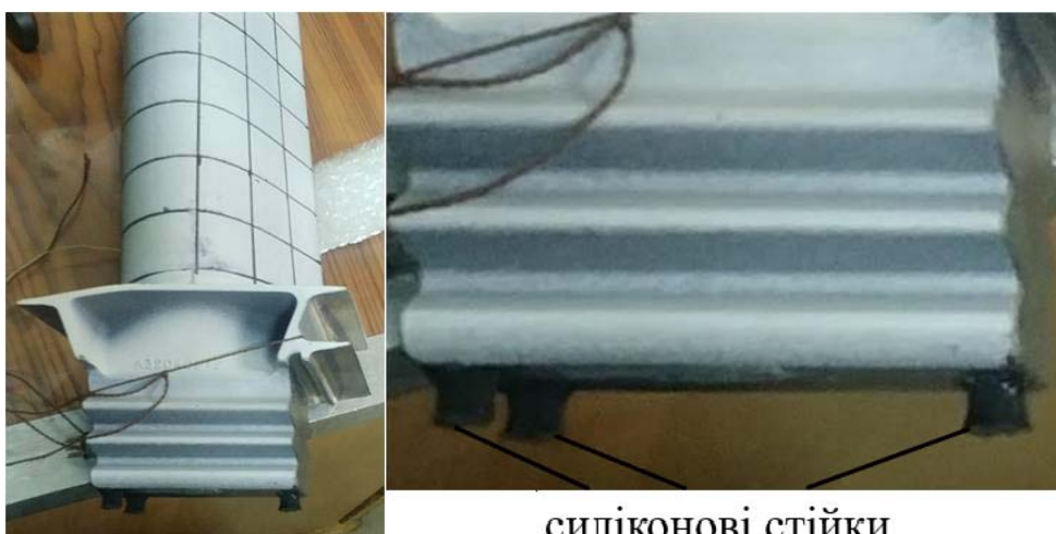
Рисунок 3 – розміщення лопатки при фактично вільних граничних умовах
