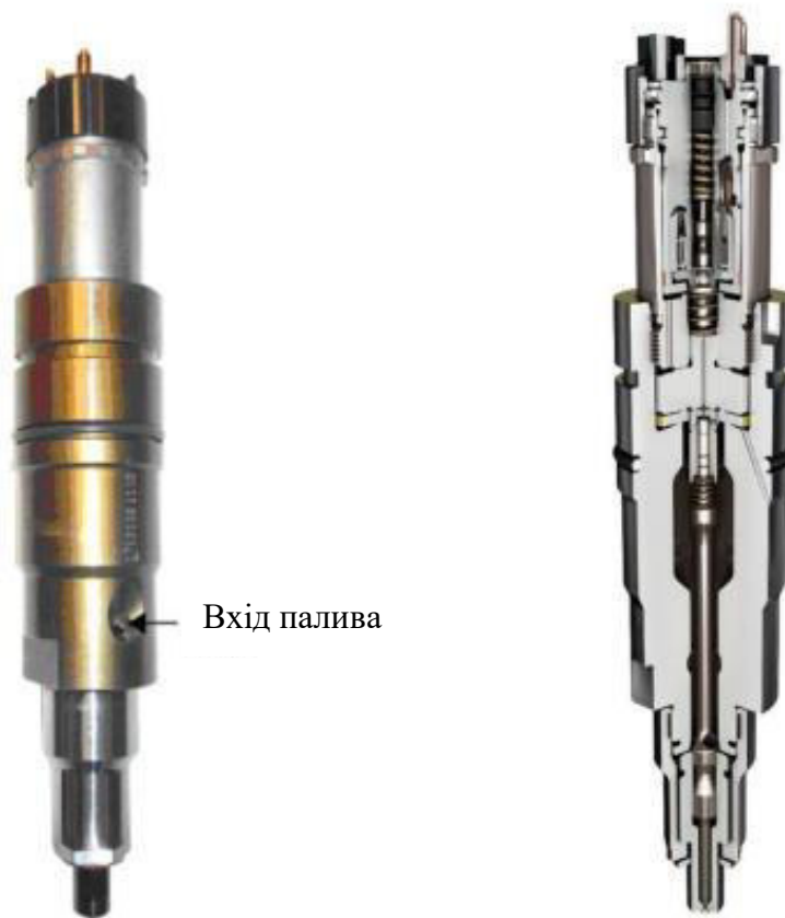
Рисунок 1.12 - Електрогідравлічна форсунка CR XPI [1-19]
