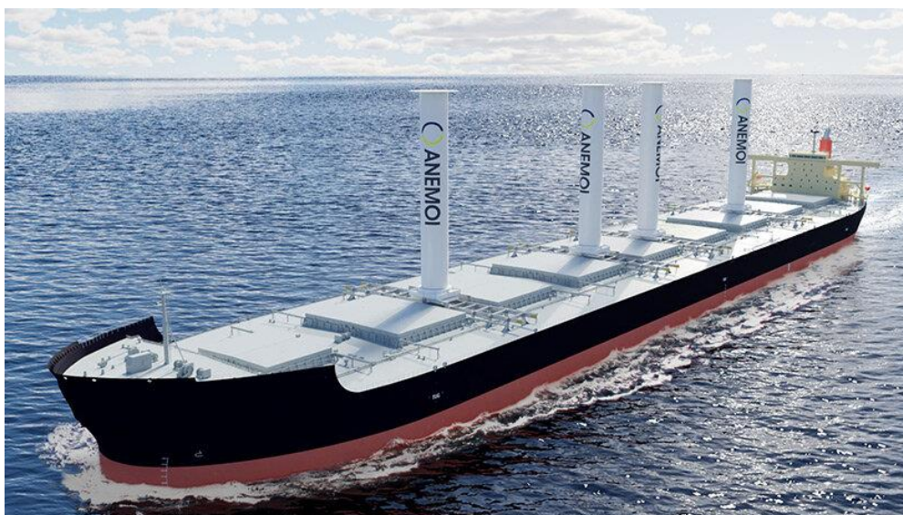
Рис. 2.6 Приклад розташування роторних вітрил [12]
