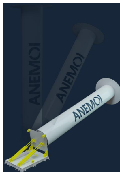
Рис 5.5 – Варіанти монтажу роторних вітрил [25]
