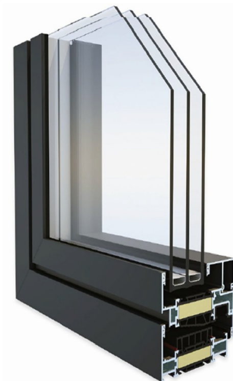
Рисунок 4.1 - Поперечний переріз алюмінієвого вікна розміром 1000 × 1000 мм зі склопакетом 4/18/4/18/4.
