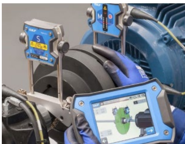
Рис.2.3.5. Зображення 3D-зображення при лазерному centruванні.
