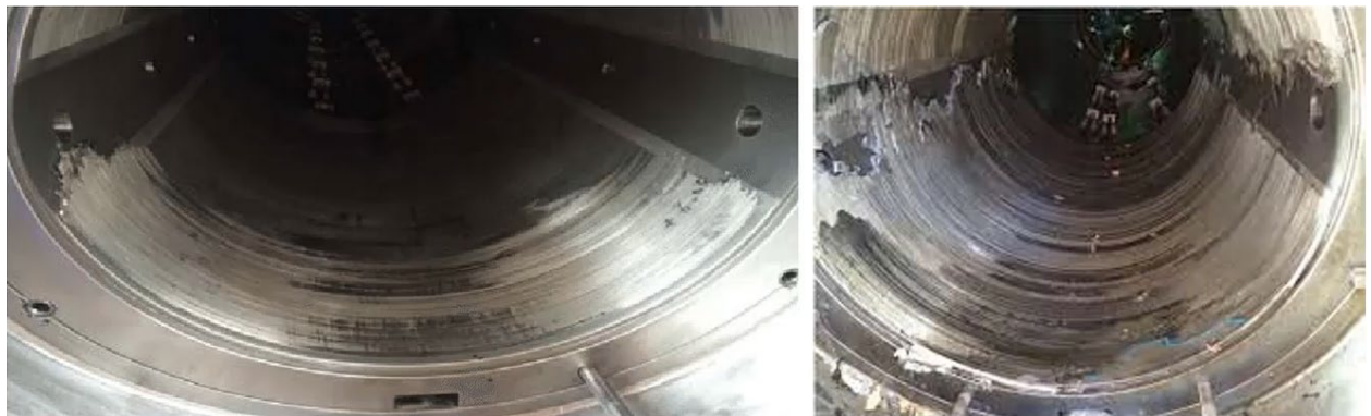
Рис.2.1.1 Плавлення підшипника внаслідок збільшеного тертя.
